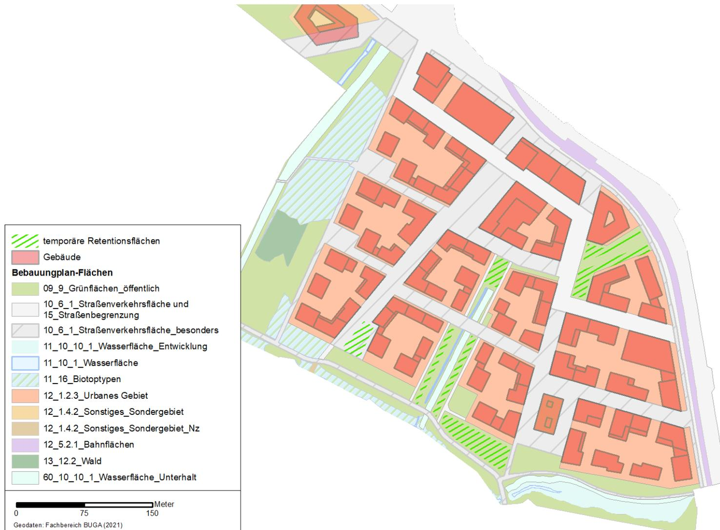
Abbildung 7-13: Im Plangebiet prinzipiell geeignete (multifunktionale) Flächen entsprechend B-Planfestsetzungen für zusätzliche Retention von Niederschlagswasser
