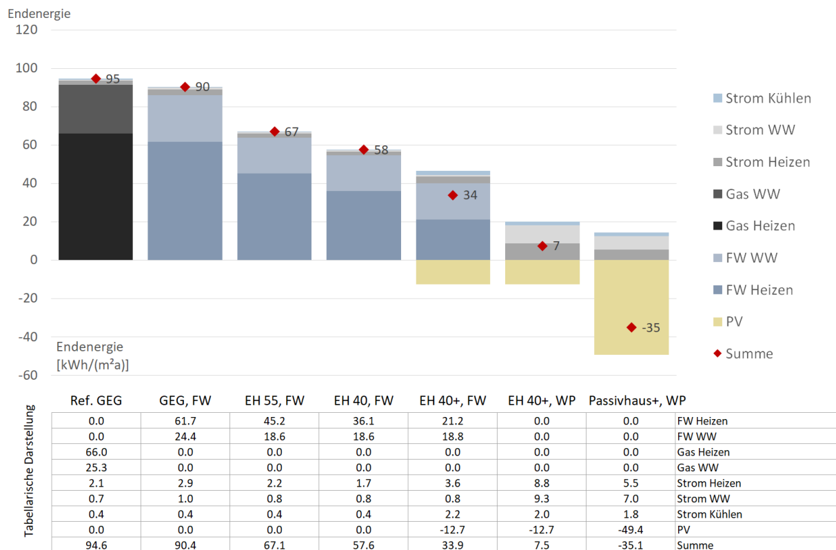
Abbildung 39 Endenergiebilanz der betrachteten Varianten. Die verschiedenen Energieträger (Strom, Gas, Fernwärme) besitzen unterschiedliche Wertigkeiten und sind daher nur bedingt miteinander vergleichbar.
